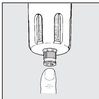
En pressant le bouton on obtient la purge des condensats même quand le circuit est sous pression.
