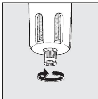
En tournant le bouton dans le sens horaire le système de purge est fermé en présence de ou en absence de pression.
