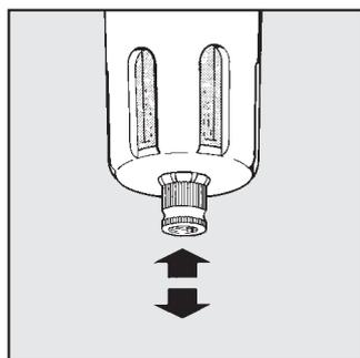
Le système de purge semi automatique est du type normalement ouvert. Quand il y a de la pression dans le circuit le système de purge est fermé. En absence de pression dans la cuve, le système de purge est ouvert et les condensats peuvent s'évacuer vers l'extérieur par gravité. Avec le bouton en position centrale la purge est en position semi automatique.
