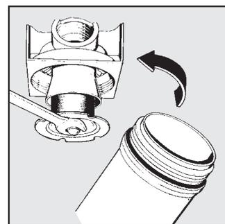
Avant démontage de la cuve, s'assurer que l'appareil n'est pas sous pression. Effectuer le démontage de la cartouche comme indiqué sur le schéma ci dessus.
